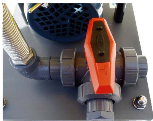
Клапан в положении DUMP (СЛИВ)
